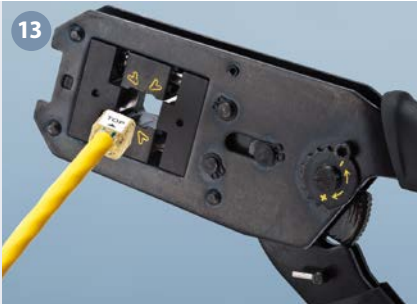
13 Kabel mit Kabelstecker in die Verpresszange einlegen... Insert cable with cable plug into the assembly tool...
