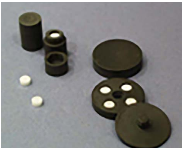
Alanindosimeter mit ESR-Messsignal
