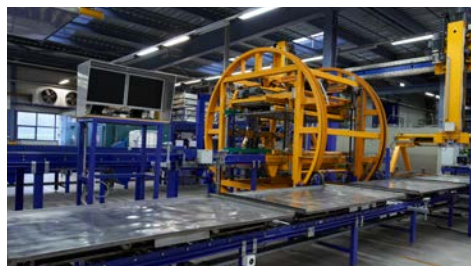
Äusseres Produktfördersystem mit Wendestation
